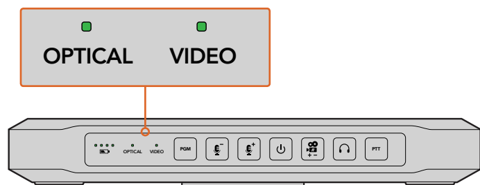
当SDI或HDMI连接上检测到有效视频信号时，ATEM Camera Converter的“Video”状态提示灯会亮起。当光纤输入上检测到有效SDI信号时，“Optical”（光纤）提示灯将会亮起。
