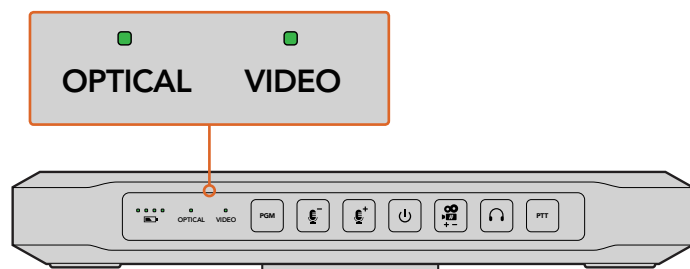
При обнаружении действительного SDI- или HDMI-сигнала на панели ATEM Camera Converter подсвечивается индикатор состояния VIDEO. Индикатор OPTICAL горит, когда на оптический интерфейс устройства поступает действительный SDI-сигнал.
